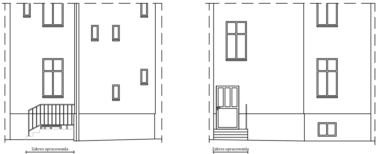
WIDOK REMONTOWANYCH SCHODÓW NA ELEWACJI BUDYNKU - STAN PROJEKTOWANY
