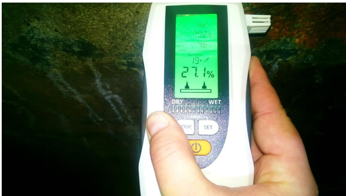
znaczne zawilgocenie ścian zewnętrznych piwnicy
