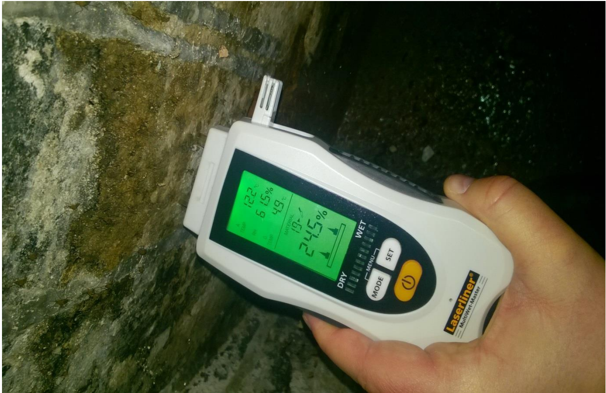
znaczne zwilgocenie murów piwnicznych
