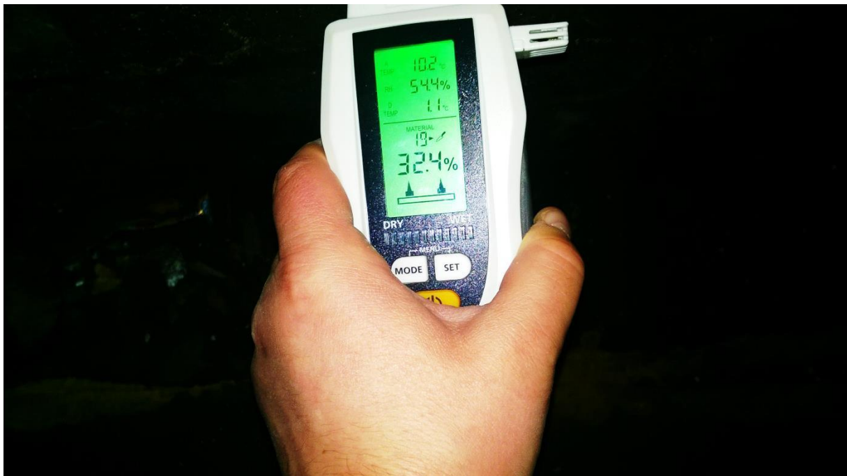
znaczne zawilgocenie ścian piwnic 32,4%
