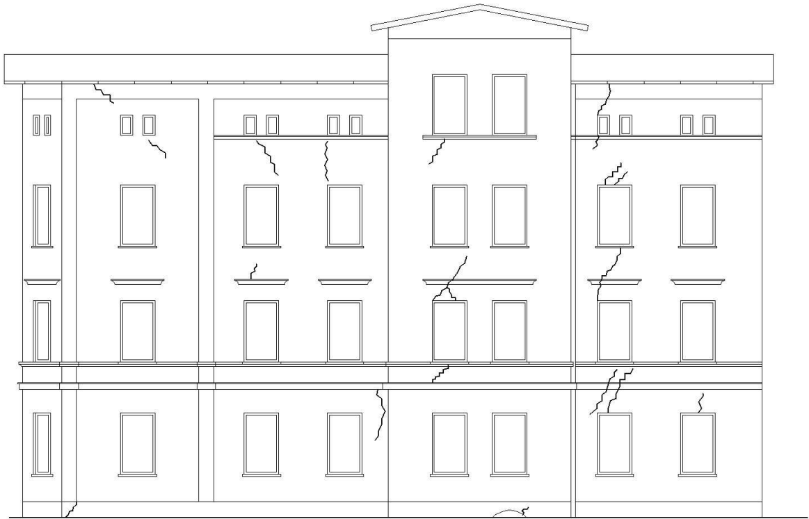
Zarysowania na ścianie „A”
