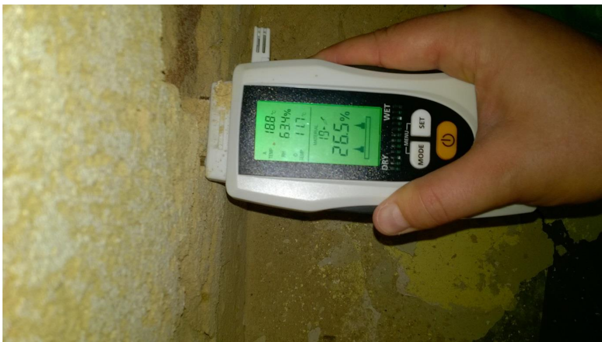
pomiar zawilgocenia ściany w pomieszczeniu pierwszego piętra
