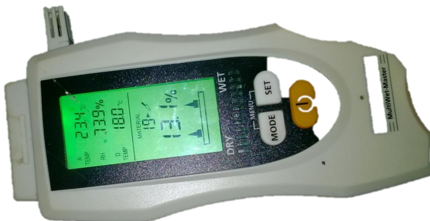
pomiar zawilgocenia w punkcie pomiarowym W1
