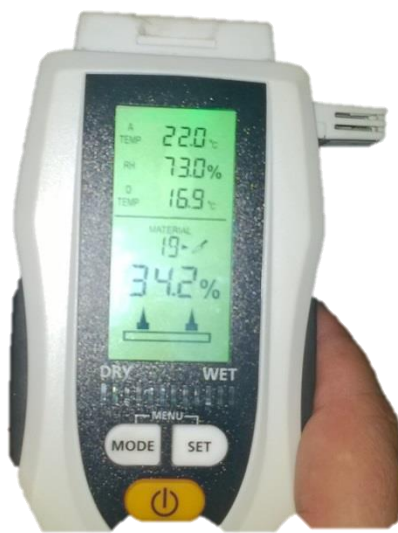
pomiar zawilgocenia w punkcie pomiarowym W1
