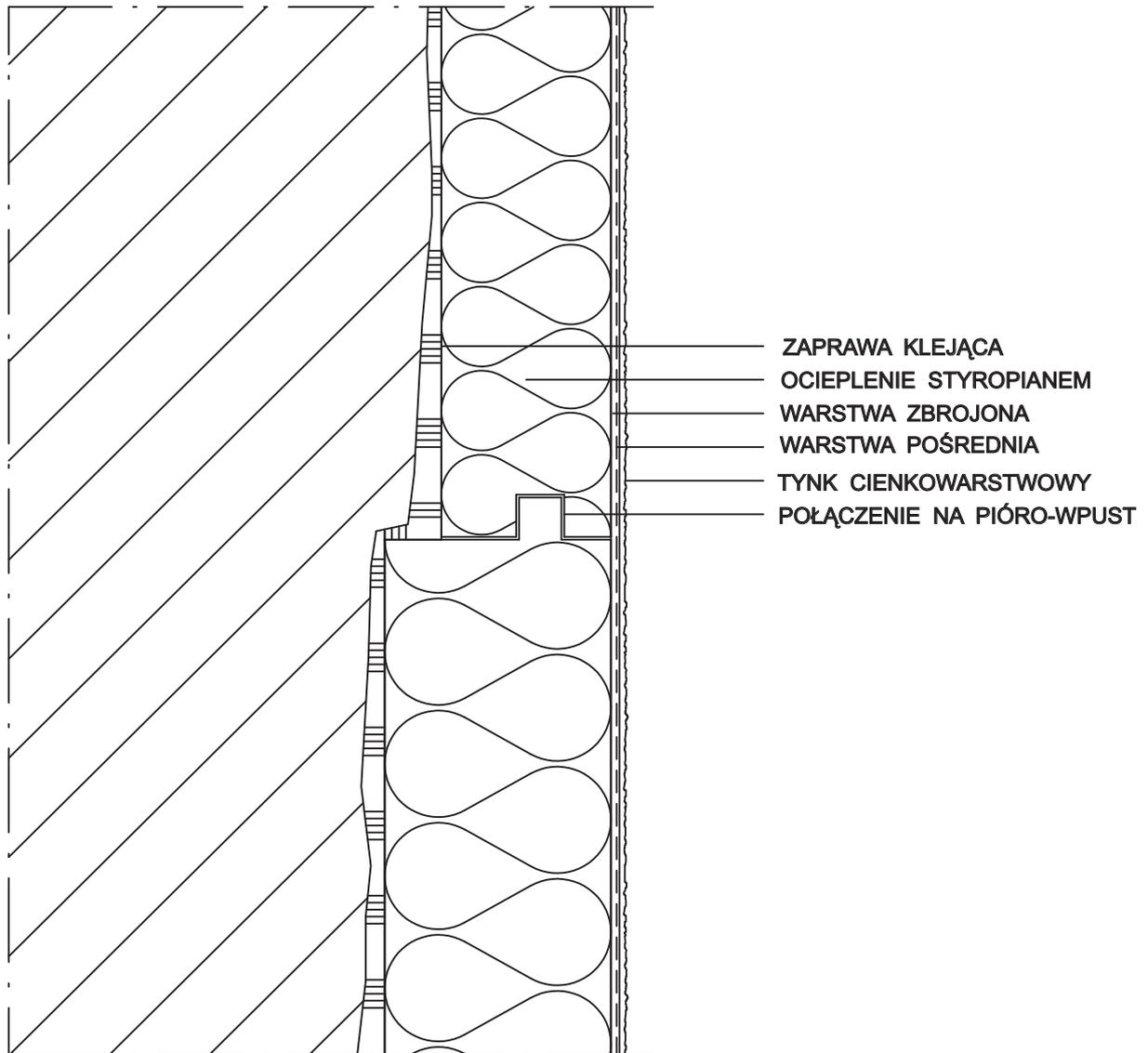
**BSO - wyrównanie nierówności elewacji systemem płyt styropianowych różnej grubości**
